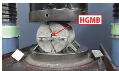
▲割裂引張試験状況
