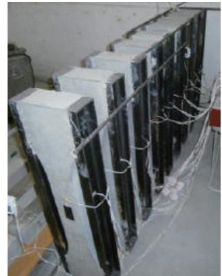
▲乾燥収縮ひび割れ試験状況
